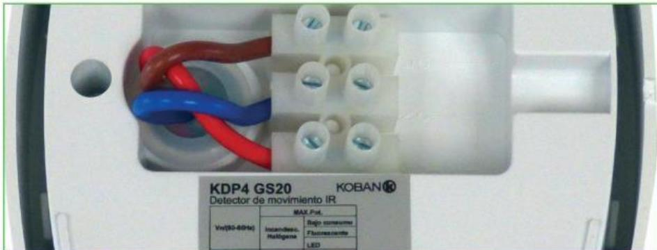
Bornas para la conexión del cableado.
